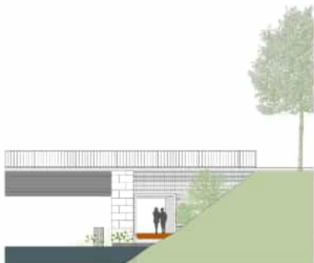
Unterquerung durch Widerlager
